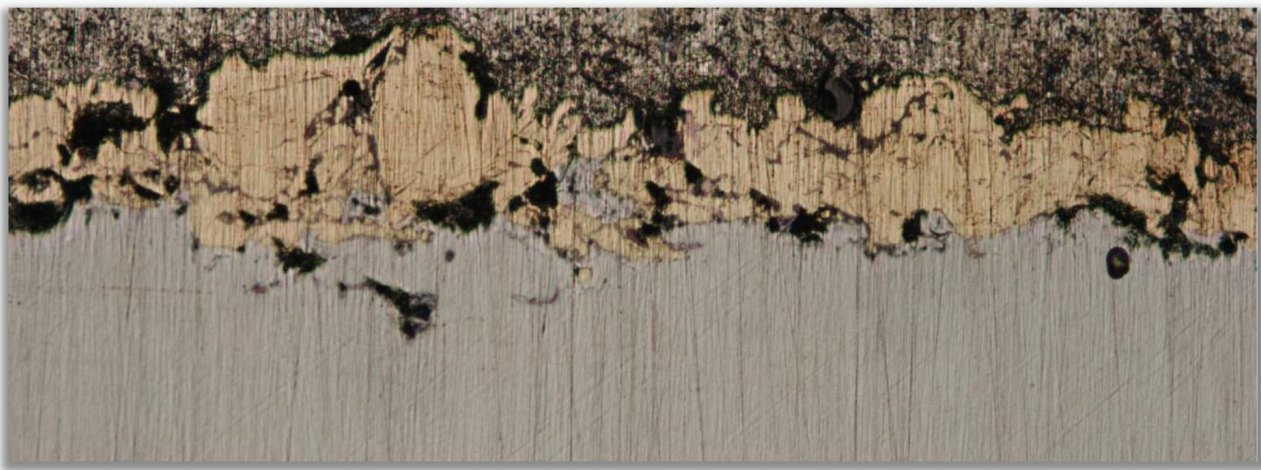
Фотография микрошлифа пористого покрытия (x200)
