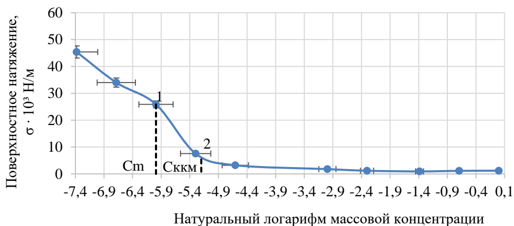
Рисунок 13 – Изотерма поверхностного натяжения экспериментального образца при T = 25^{\circ}\text{C} в координатах \sigma = f(\ln C) : C_m – концентрация насыщения адсорбционного слоя (соответствует точке 1 на кривой); C_{ккм} – критическая концентрация мицеллообразования (соответствует точке 2 на кривой)
