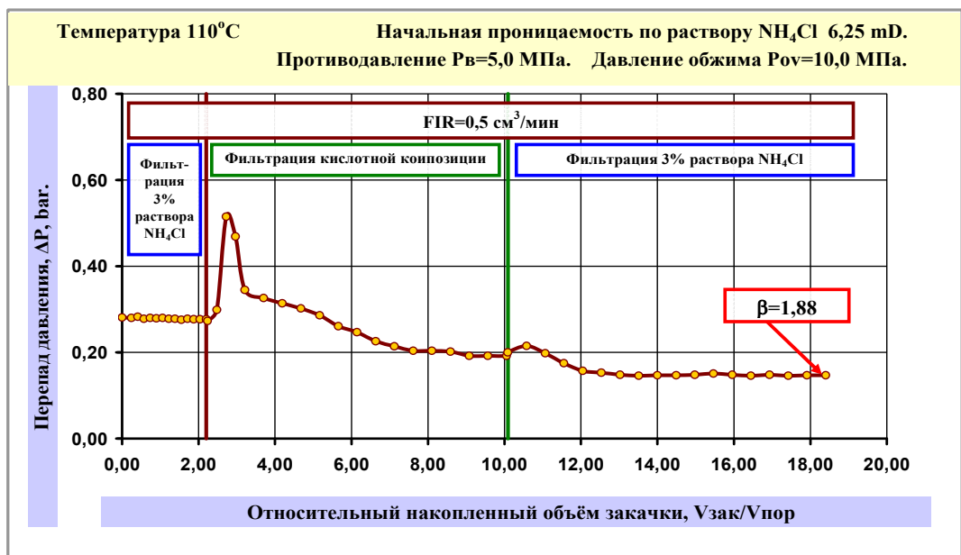
Рисунок 4 - Динамика перепада давления при последовательной фильтрации 3 % раствора NH 4 Cl, кислотной композиции 2.4 и 3 % раствора NH 4 Cl в образец керна ВН-16
