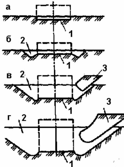
При малых энергиях (скоростях) удара поверхность породы восстанавливается полностью и следов разрушения на ней не заметно (упругое деформирование). Этим условиям соответствует зависимость  $F_z(x)$ , описываемая кривой 1 на первом рисунке. При небольшом увеличении энергии удара на поверхности остается лишь след ударника (остаточная деформация) в виде зоны трещин, окружающих контур ударника (схема а).
