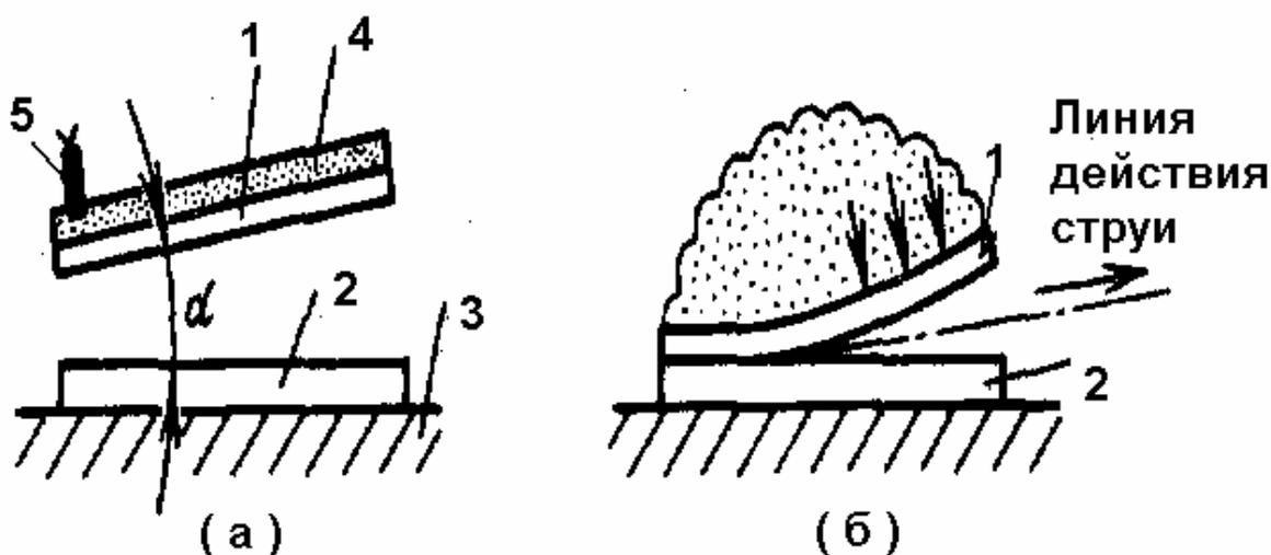
**Схема сварки взрывом.**
