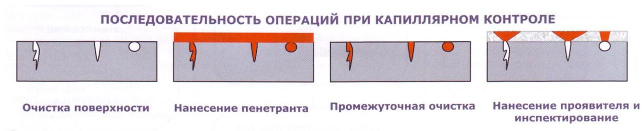
Рисунок 1 - Основные операции при капиллярной дефектоскопии
