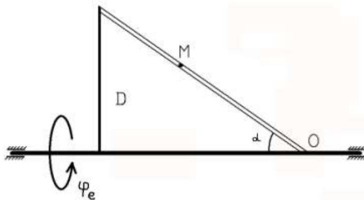
Точка  $M$  движется относительно тела  $D$ . По заданным уравнениям относительного движения точки  $M$  и движения тела  $D$  определить для момента времени  $t = t_1$  абсолютную скорость и абсолютное ускорение точки  $M$ . Исходные данные приведены в таблице:
