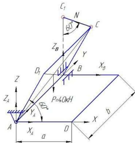
Дано:  $P=40 \text{ кН}$ ;  $AD=AD_1$ . Определить реакции опор.
