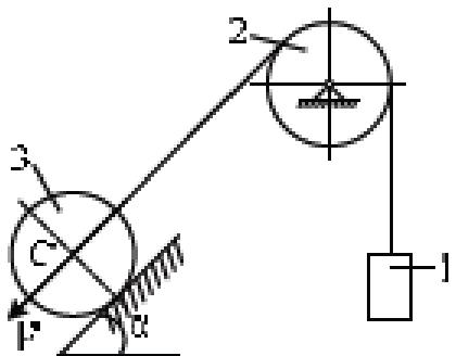
Для механической системы, которая приходит в движение из состояния покоя, определить скорость  $V_1$  как функцию вертикальной координаты груза 1. Считать, что у блока и катка массы распределены по наружному радиусу. Нить считать невесомой и нерастяжимой; проскальзывание отсутствует. Трением качения и трением скольжения пренебречь.  $m_3 = m_2 = 2m_1$ .  $F = m_1 g$ .
