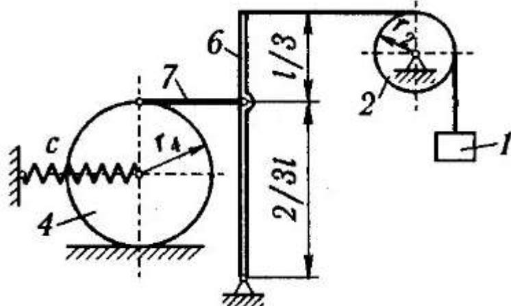
Определить частоту и период малых свободных колебаний механической системы с одной степенью свободы, пренебрегая силами сопротивления и массами нитей.
