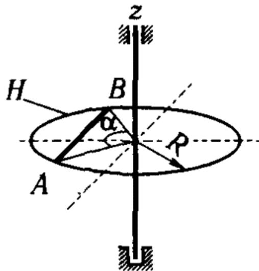
Дано:  $m_1=200 \text{ кг}; m_2=60 \text{ кг}; \omega_0=-2 \text{ рад/с}, R=2 \text{ м}; \alpha=120 \text{ град}; AO=3^{1/2}/2 \text{ м}; M_z=M_z(t)=101 \text{ Н}\cdot\text{м}; \tau=5 \text{ с}; OK=s=s(t_1)=3^{1/2} (t_1)^2; T=1 \text{ с}.$  Определить угловую скорость  $\omega_t$  тела H в момент  $t=\tau$ . Определить угловую скорость  $\omega_T$  тела H при  $t_1=T$ .
