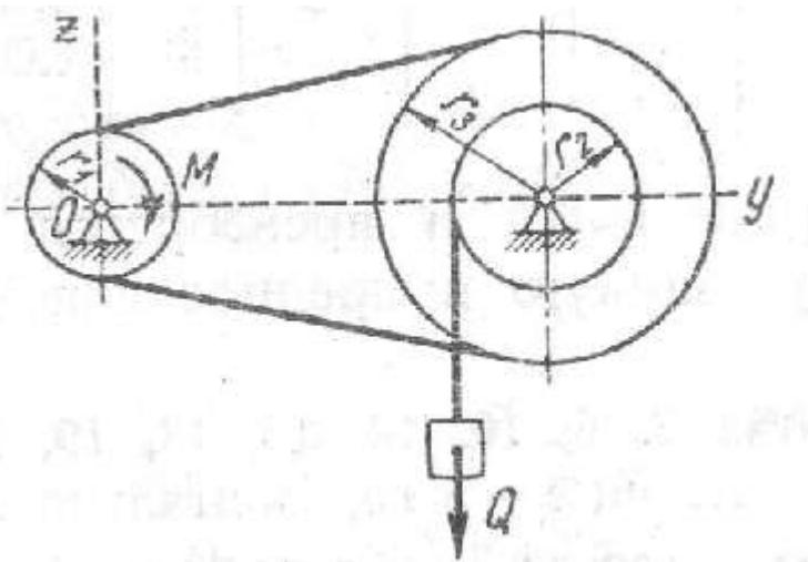
Дано:  $M = 80 \text{ Нм}$ ,  $r_1 = 0,2\text{м}$ ,  $r_2 = 0,3\text{м}$ ,  $r_3 = 0,5\text{м}$ . Найти силу  $Q$ .
