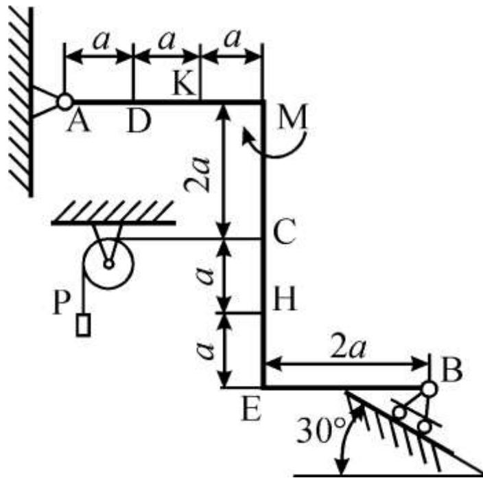
Дано:  $P = 25 \text{ кН}$ ,  $M = 100 \text{ кНм}$ ,  $a = 1 \text{ м}$ . Определить реакции опор.
