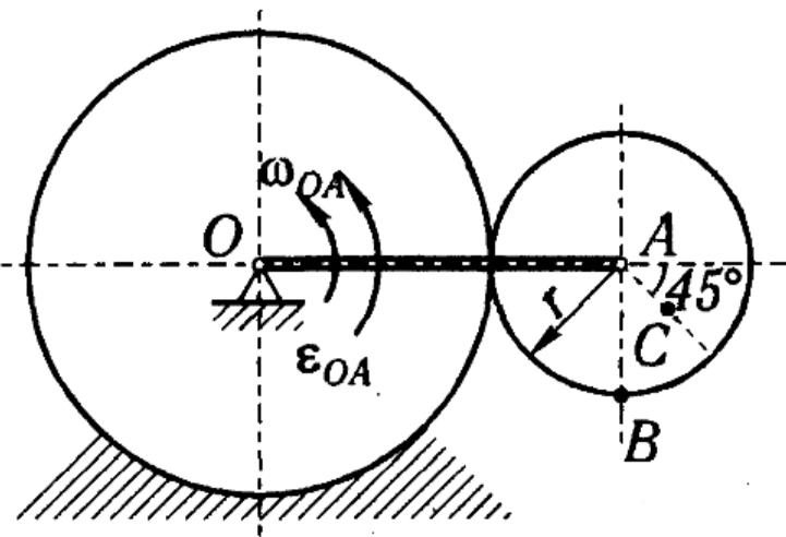
Дано:  $OA = 40 \text{ см}$ ,  $r = 15 \text{ см}$ ,  $AC = 8 \text{ см}$ ;  $\omega_{OA} = 2 \text{ рад/с}$ ,  $\epsilon_{OA} = 2 \text{ рад/с}^2$ . Найти для заданного положения механизма скорости и ускорения точек В и С, а также угловую скорость и угловое ускорение звена, которому эти точки принадлежат.
