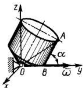
Тело вращается вокруг неподвижной точки  $O$ , катясь по плоскости  $Oxy$  с угловой скоростью  $\omega = 1 \text{ рад/с}$ . Определить скорость точки  $A$ , если расстояние  $OA = 0,5 \text{ м}$ ,  $\alpha = 60^\circ$ ,  $OB = AB$ .
