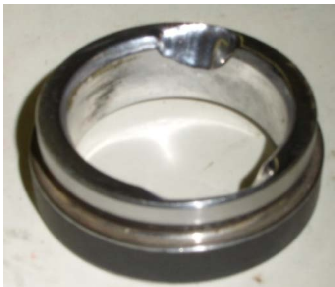
Рис. 31. Гидроабразивный износ седла клапана штангового насоса.
