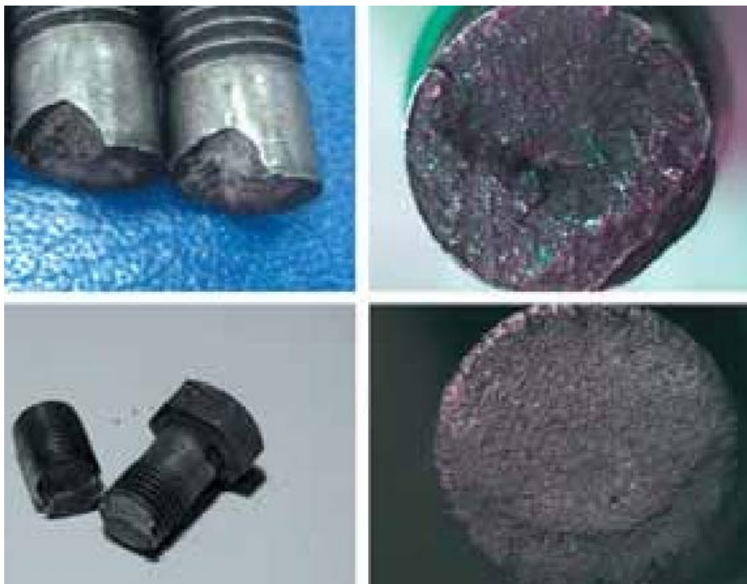
Рис.24. Усталостное разрушение болтов.
