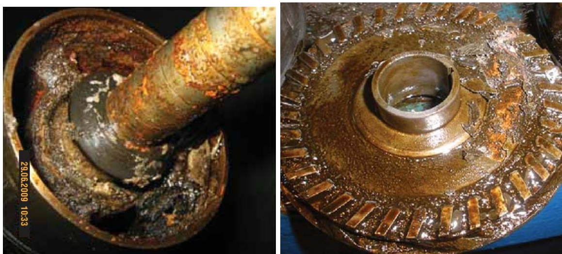
Рис. 27. Механические примеси в рабочих ступенях УЭЦН.
