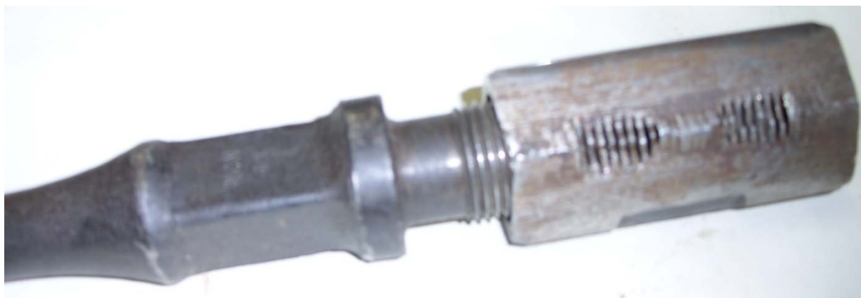
Рис. 26. Износ муфты насосных штанг
