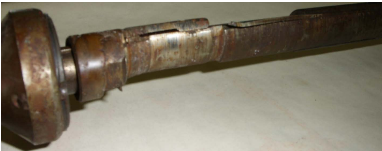
Рис. 36. Износ вала газосепаратора УЭЦН.
