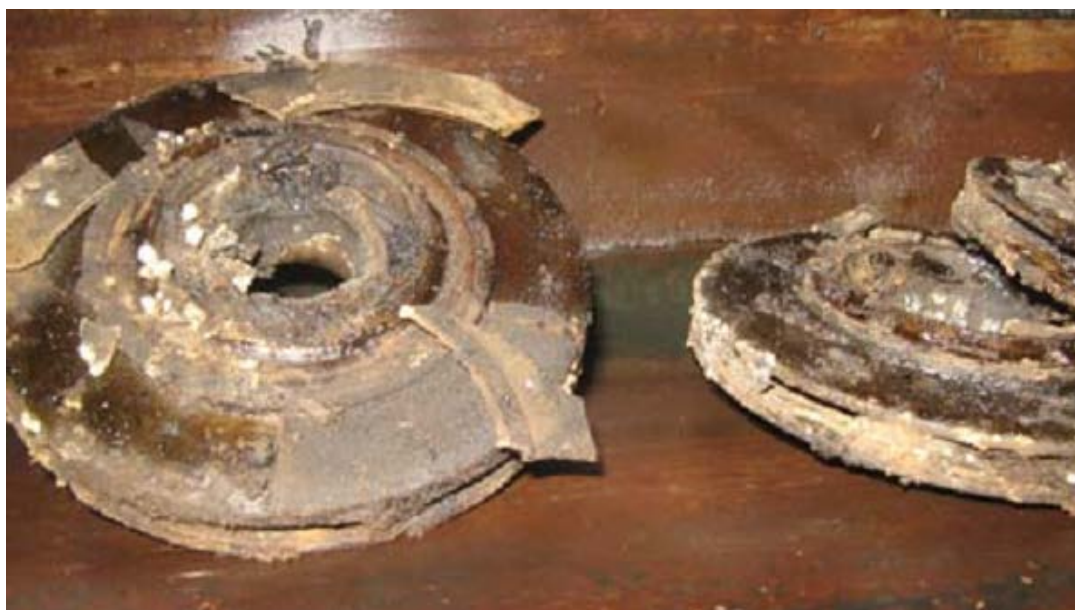
Рис.28. Отложение солей в рабочих колесах УЭЦН.
