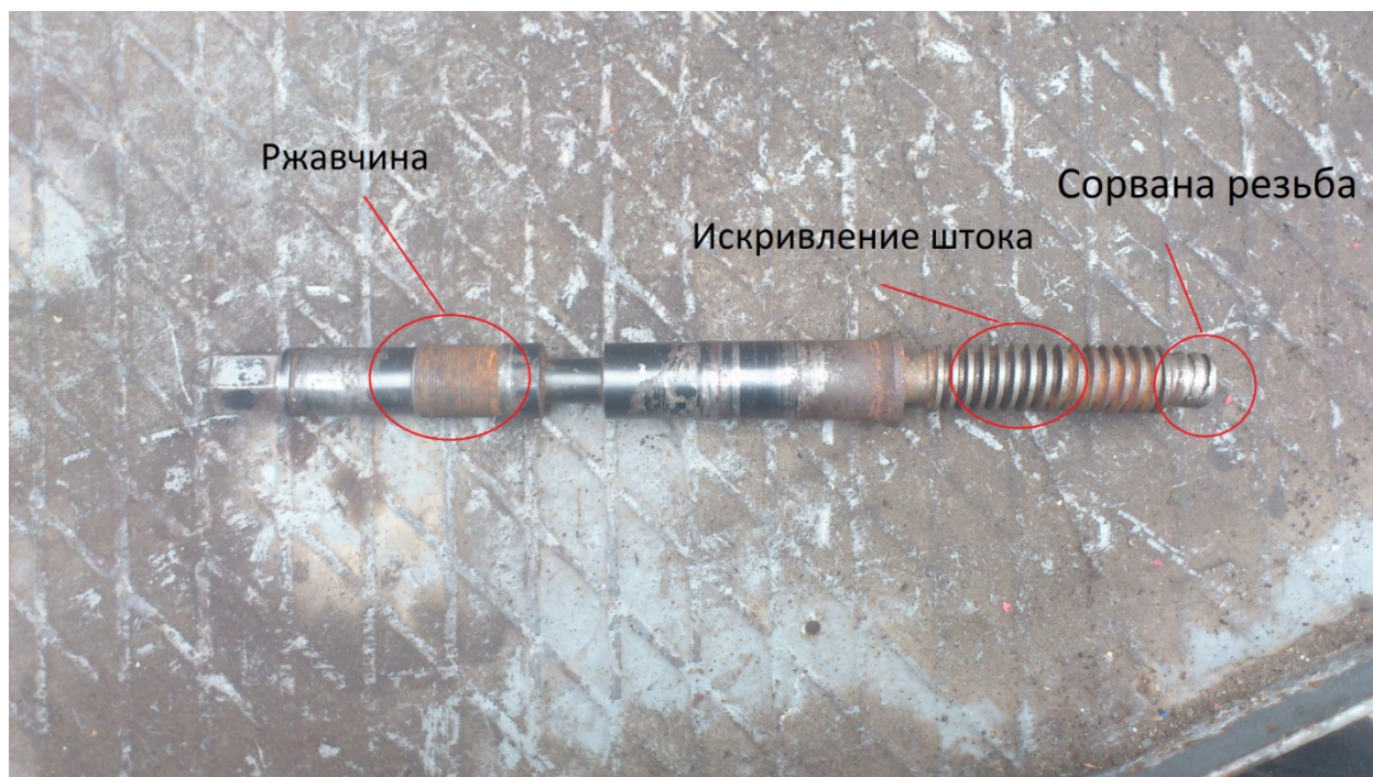
Рис.40. Фотография шпинделя шиберной задвижки с указанием обнаруженных дефектов.
