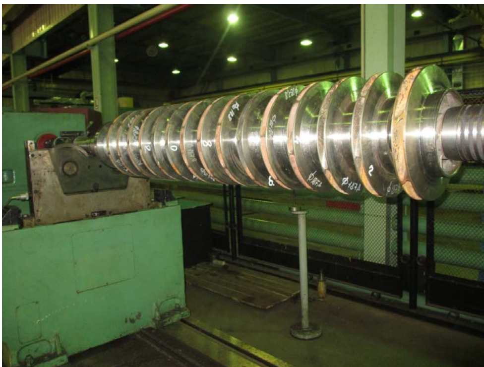
Рис. 44. Балансировка вала насоса типа ЦНС с установленными на нем рабочими колесами.
