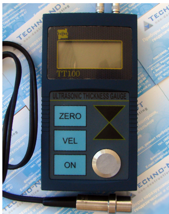
Рис. 21. Универсальный ультразвуковой толщиномер– ТТ100, для определения толщины металлических, пластмассовых, керамических изделий, изделий, изготовленных из сплавов металлов и других материалов.
