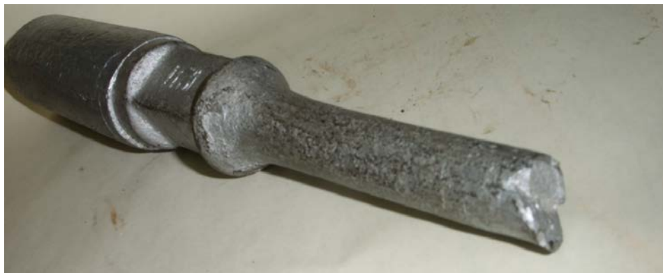
Рис. 25. Коррозионно-усталостное разрушение насосной штанги.
