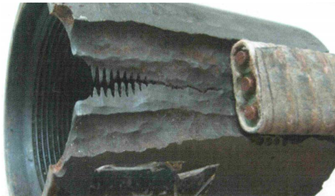
Рис.34. Электрокоррозия муфты НКТ.
