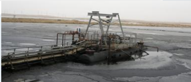
Установка по переработке нефтяных шламов из прудов и лагун
